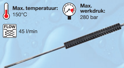
Rechte lans - dichte isolatie - 1/4" BSPT inlaat/uitlaat
