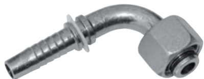
90° bocht - metrisch male 24° conus - serie L met O-ring (DIN 3853)
