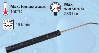
Gebogen lans - open isolatie - 1/4" BSPT inlaat/uitlaat
